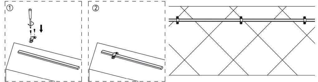
Zur dauerhaften Befestigung verwenden Sie geeignete Schellen oder Halter. Benutzen Sie keinen dünnen Draht oder Ähnliches zum Befestigen, der könnte die Kunststoffbeschichtung beschädigen. Bei längerer bzw. dauerhafter Installation muss der LED-Stripe schwingungsfrei befestigt werden, um Leitungsbrüche zu verhindern.
