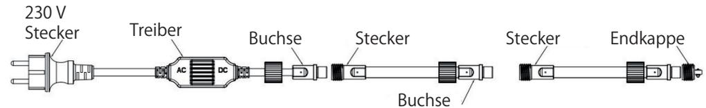
Zur Erweiterung des LED-Stripes stecken Sie die Stecker und Buchsen zusammen. Achten Sie bitte darauf das die Überwurfmutter und die Endkappe korrekt und fest verschraubt sind!
