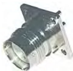
Twinax-Flanschbuchse mit Vierkantflansch 25,4 mm, 4 Löcher ø 3 mm, Kontakte zum Lötten oder Crimpen mit Zange C 95 LC
